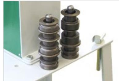
Abb.: Walzenaufnahme mit Standardwalzen
