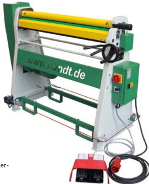
Abb.: RME 65/1000 mit Stapler-Transportvorrichtung und Hundt-Feder-Fingerschutz
